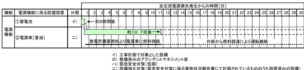
図 4. 4. 5 運転時の電源機能継続時間に係る評価結果
