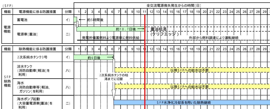
図4.4.3 運転時のクリフエッジ所在の特定結果
