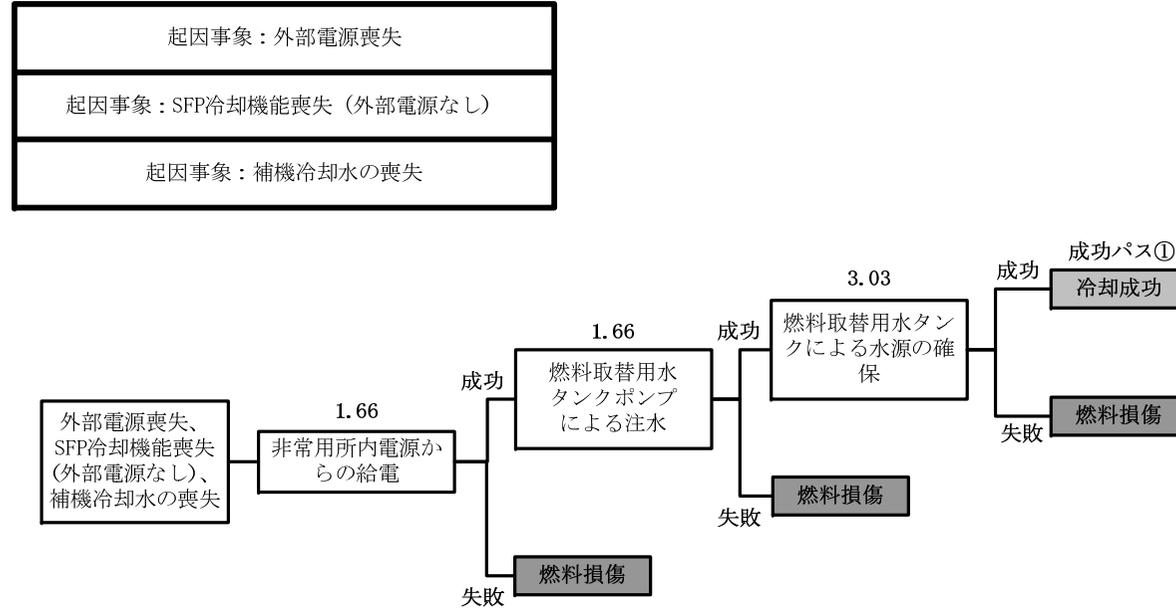
イベントツリーの耐震裕度およびクリフエッジ評価（緊急安全対策前）（地震：SFP燃料損傷）
