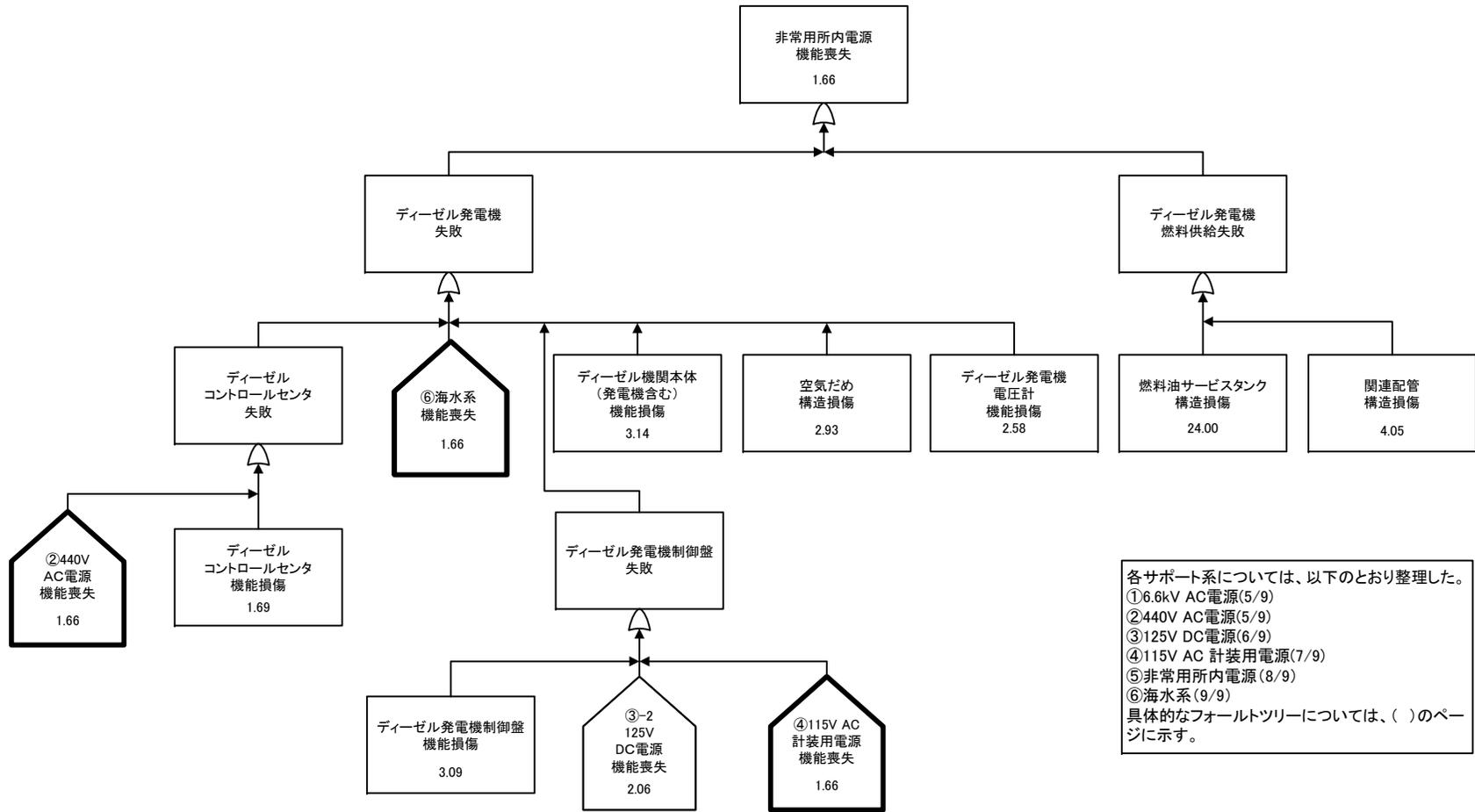
各影響緩和機能のフォールトツリー（地震：SFP燃料損傷）
