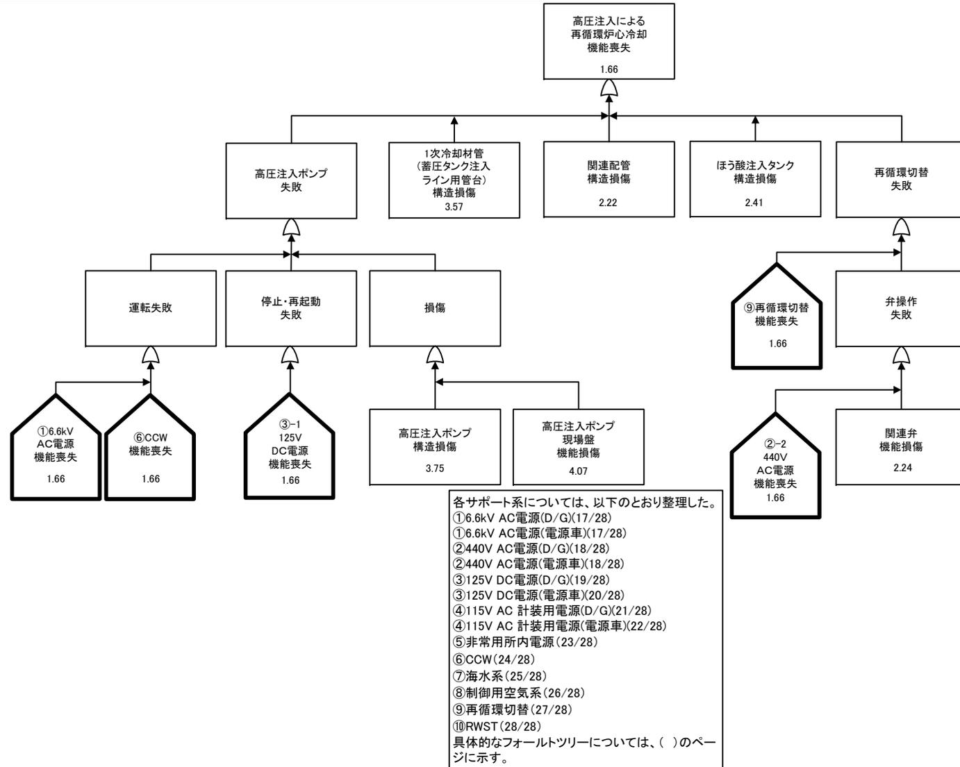
各影響緩和機能のフォールトツリー (地震：炉心損傷)
