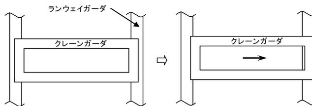
補助建家クレーンが水平移動した場合のイメージおよび寸法図
