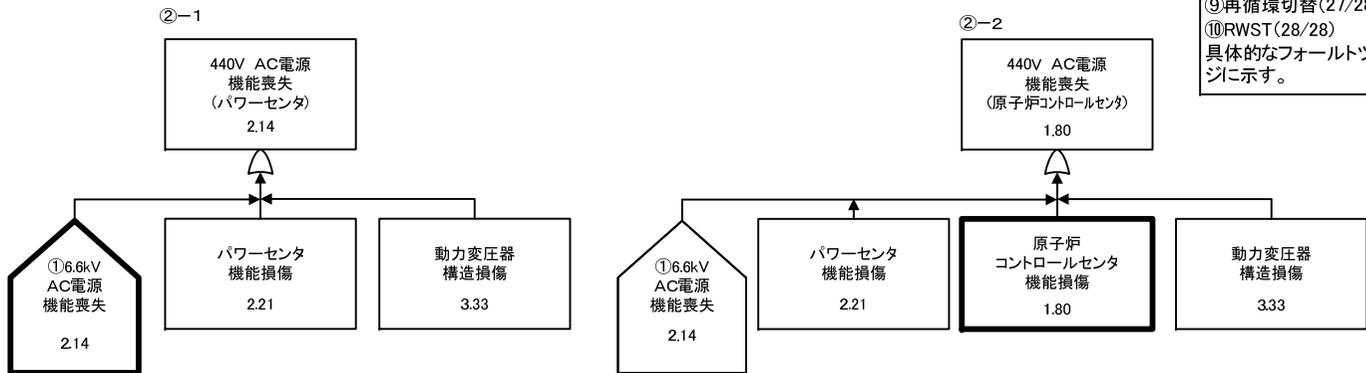
各影響緩和機能のフォールトツリー (地震：炉心損傷)
