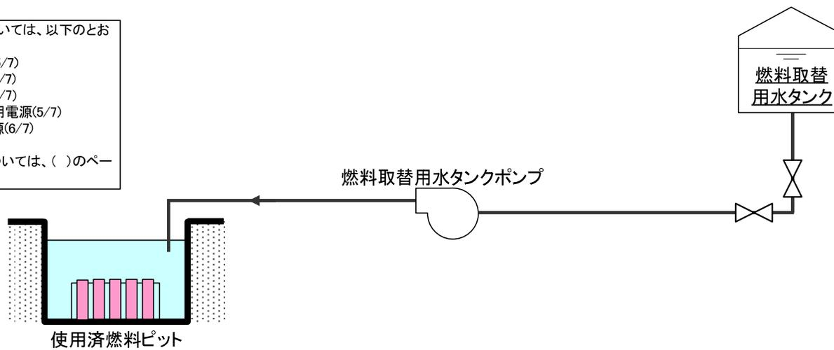
各影響緩和機能の系統図 (地震: SFP 燃料損傷)
