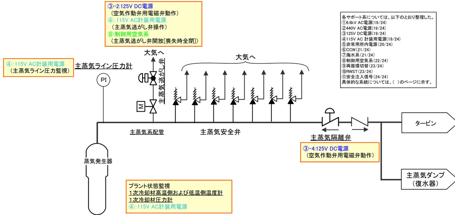
各影響緩和機能の系統図 (地震：炉心損傷)
