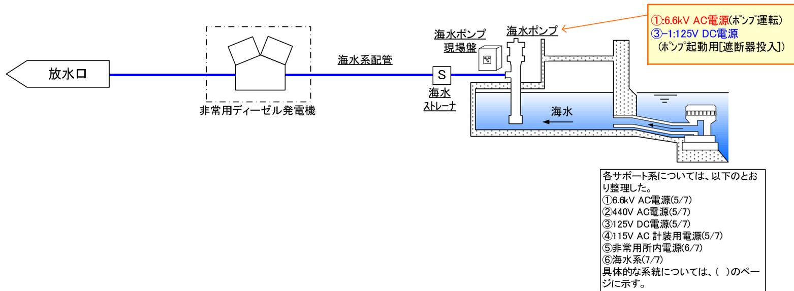
各影響緩和機能の系統図（地震：SFP 燃料損傷）
