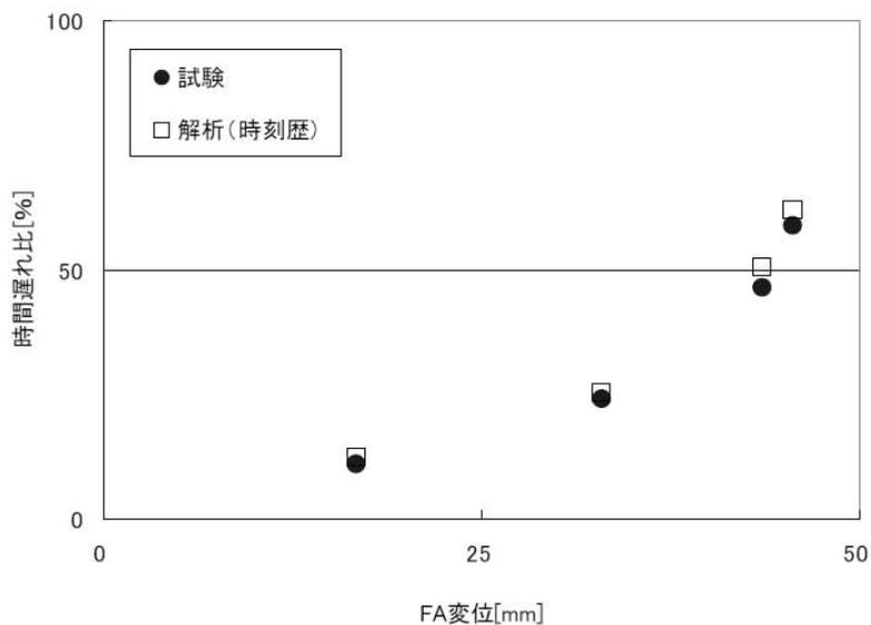
図 5.3.3-17 燃料集合体変位と挿入時間遅れ
