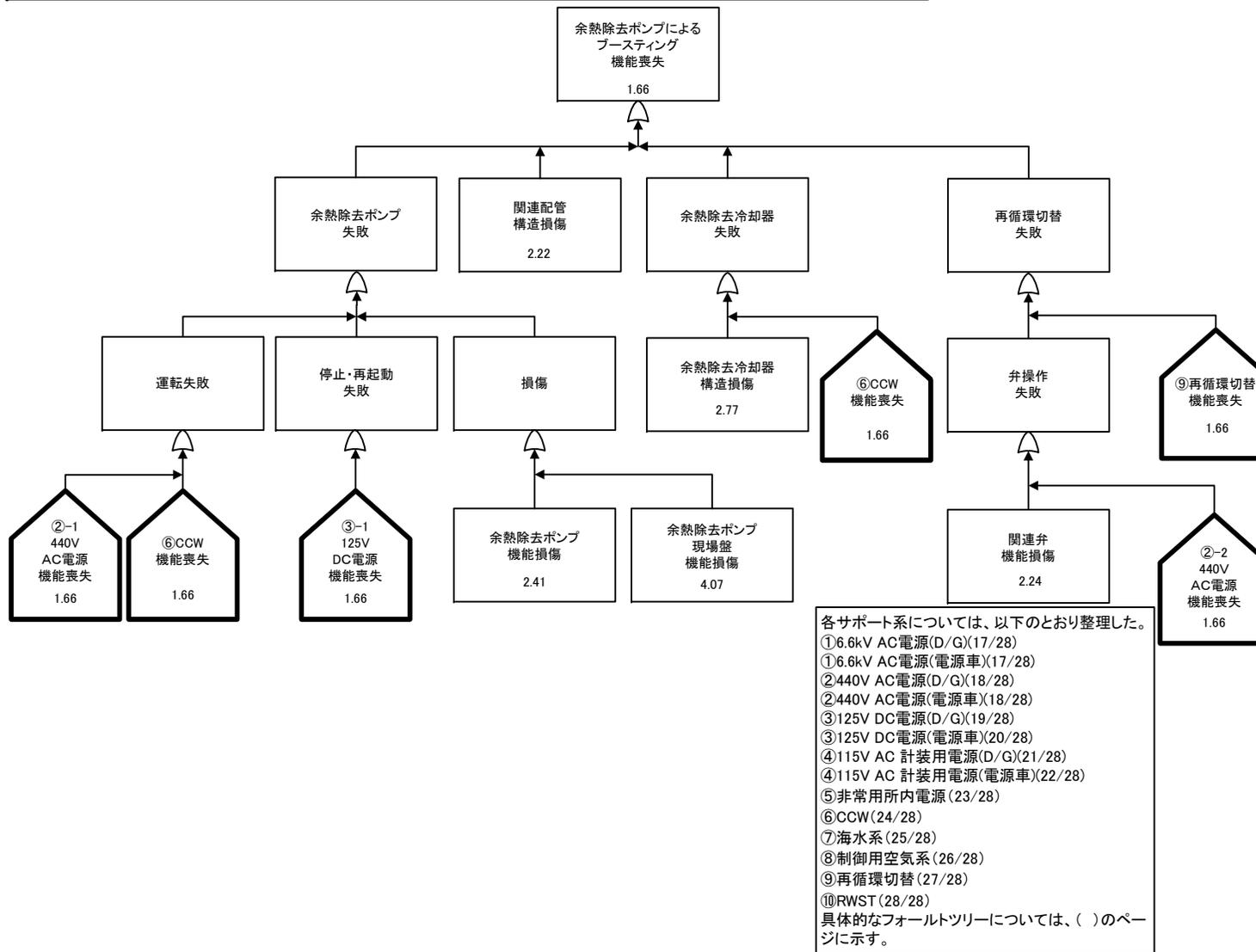
各影響緩和機能のフォールトツリー (地震：炉心損傷)
