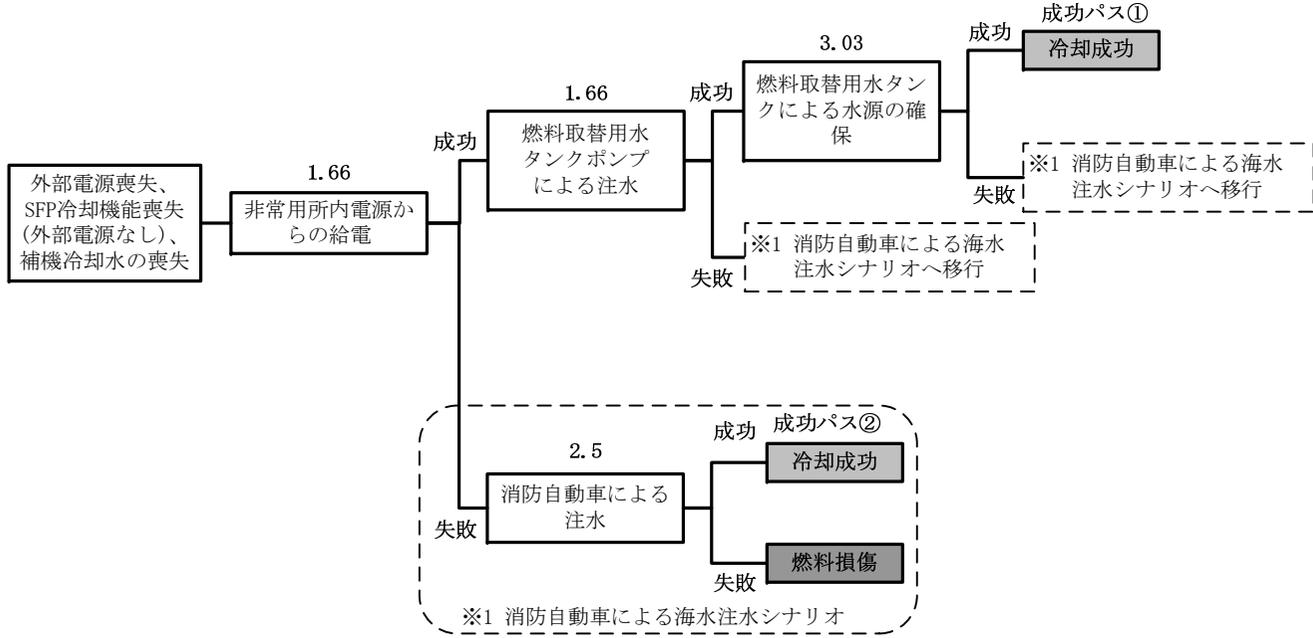
イベントツリーの耐震裕度およびクリフエッジ評価（地震：SFP燃料損傷）
