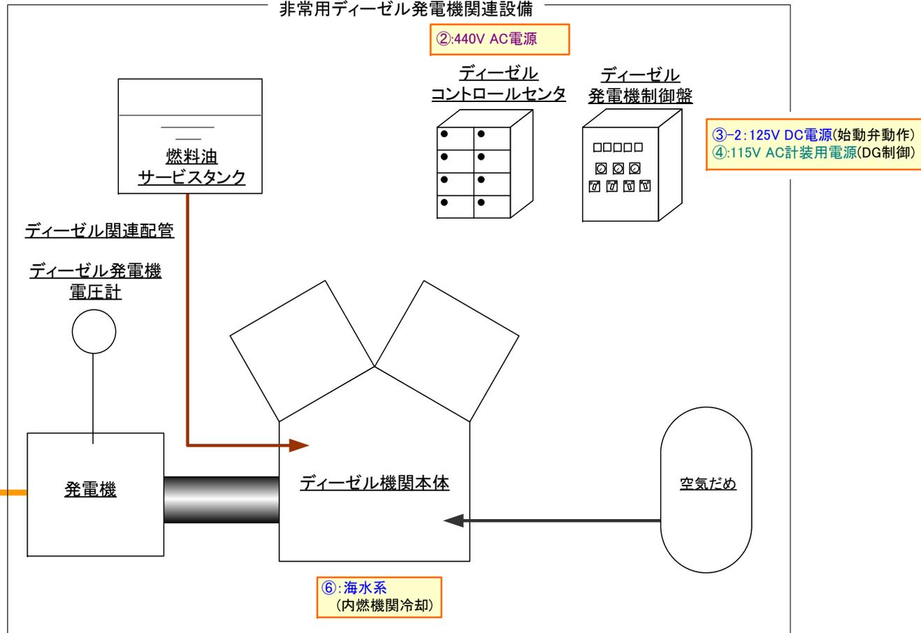
各影響緩和機能の系統図 (地震: SFP 燃料損傷)
