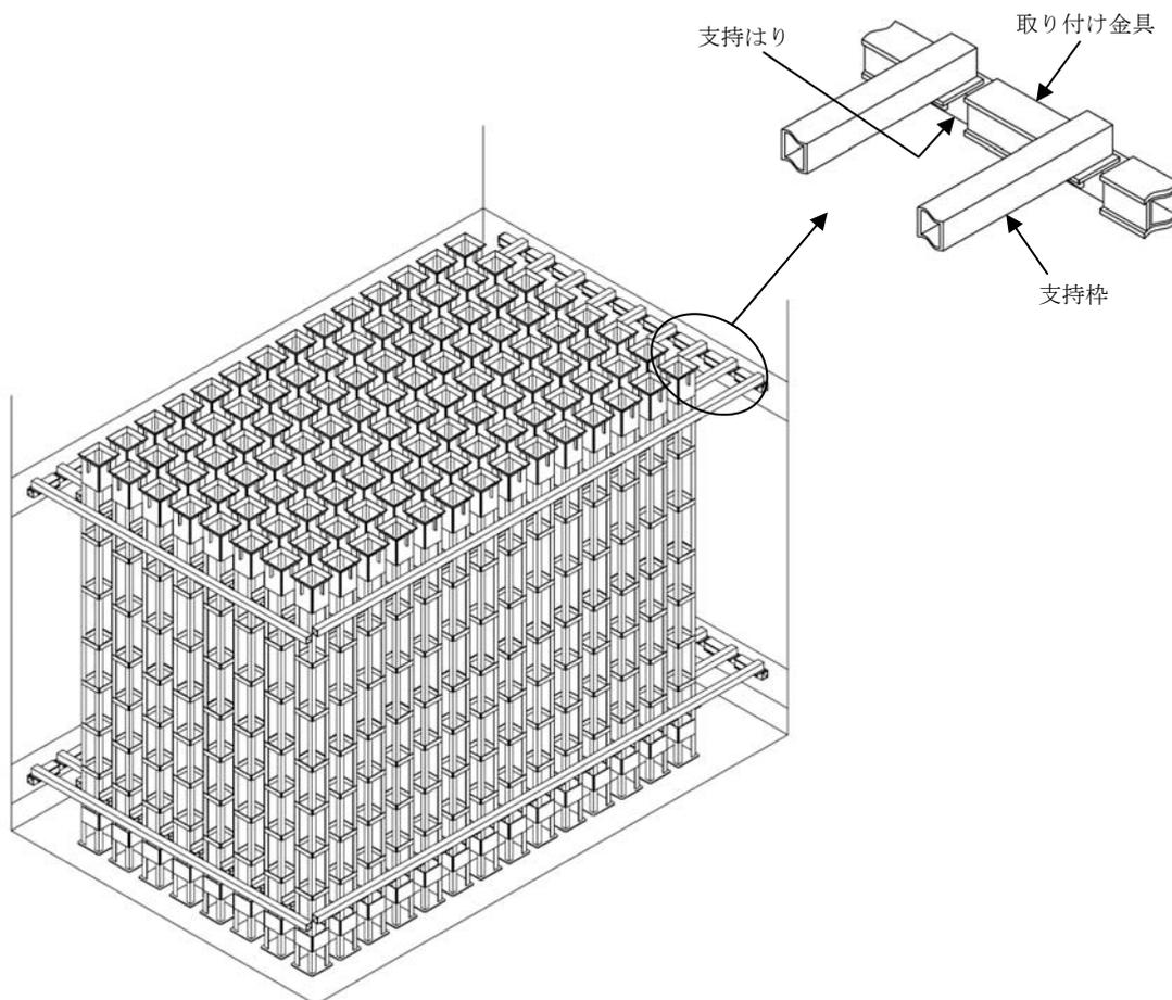
図1 サポート部の構造例（壁支持型：伊方2号機）
