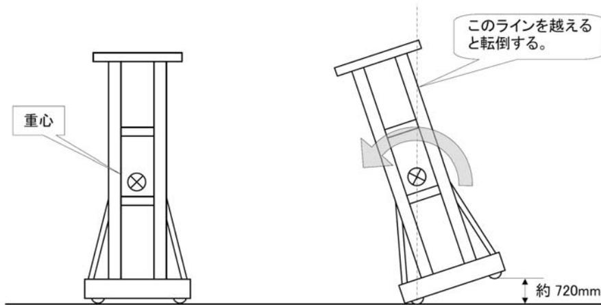
図 2 クレーン転倒の許容値概念図
