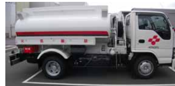
非常用ディーゼル発電機等に用いる重油、および電源車等に用いる軽油の円滑な補給のため、移送配管の設置やミニローリーを配備
