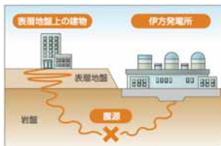
岩盤上に設置した伊方発電所と表層地盤上の建物の揺れの伝わり方の違い
