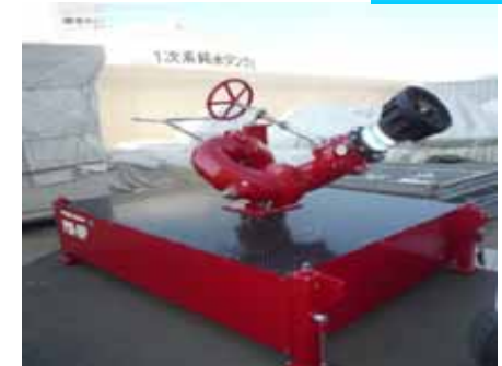
放水砲 (大型 2台)
