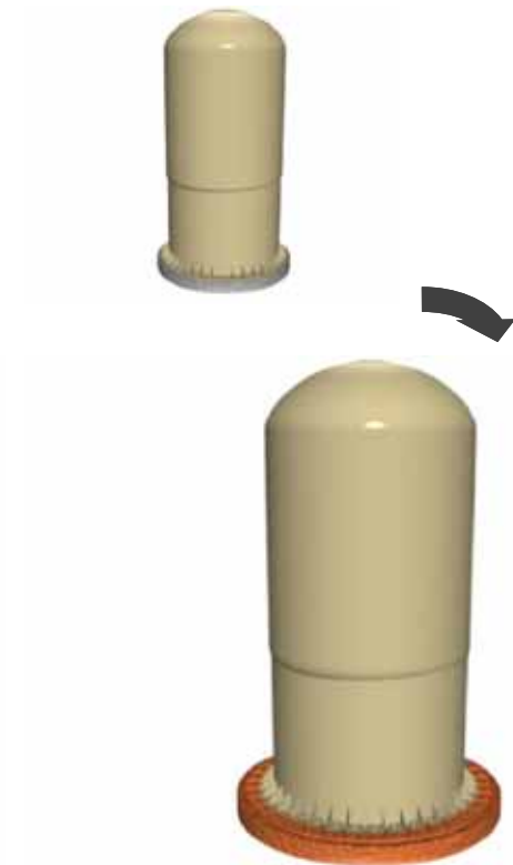
蓄圧タンク (支持構造物[タンク基礎部]の補強)
