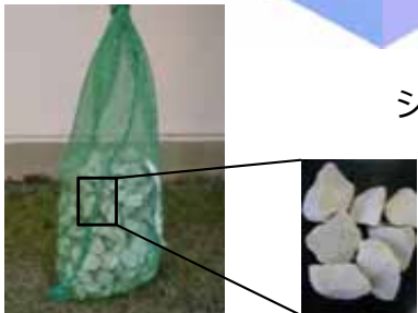
放射性物質吸着剤 (ゼオライト) (雨水排水弁等に設置)
