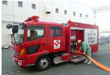
加圧ポンプ車
