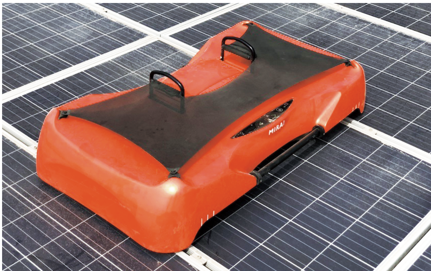
画像は稼働中のソーラーパネル清掃ロボット-タイプ1 / 2019年上半期に巨大太陽光発電所向けの新型モデルを量産開始予定
