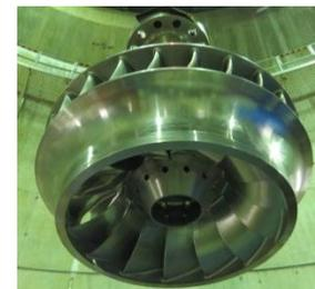
水の流れのロスを低減させるため、流動解析によって羽根形状を最適化し、羽根(長翼)の間に短い羽根(短翼)を設置
