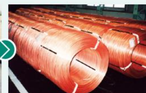
再生された電線
