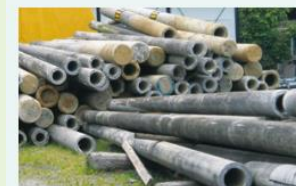
再生処理前のコンクリート柱
