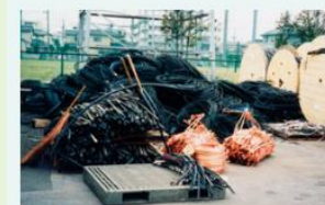
再生処理前の電線
