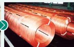
再生された電線
