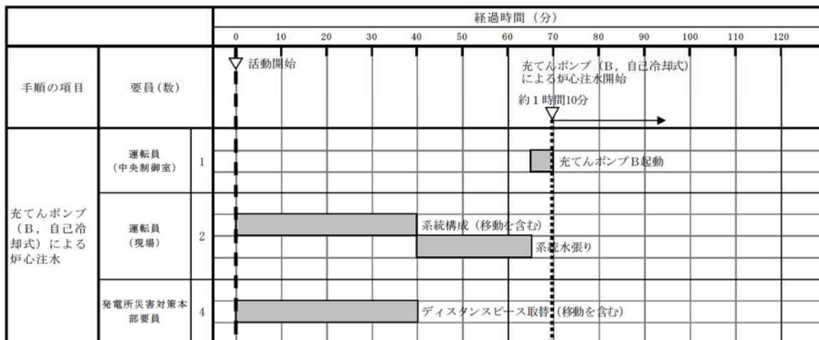
第 1.4.25 図 充電ポンプ (B, 自己冷却式) による炉心注水 タイムチャート
