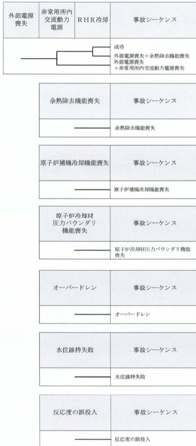
第 3.3 図 停止時内部事象 P R A 用イベントツリー
