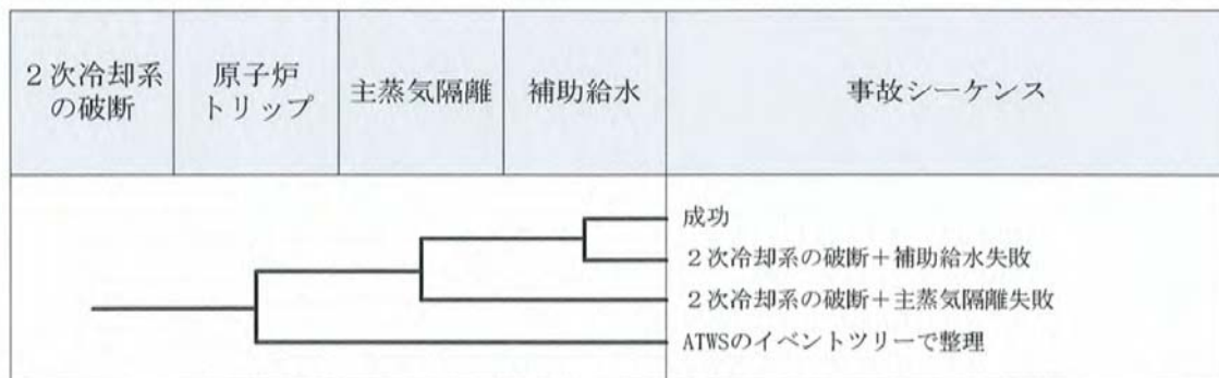
第 4. 1. 4-9 図 2 次冷却系の破断イベントツリー
