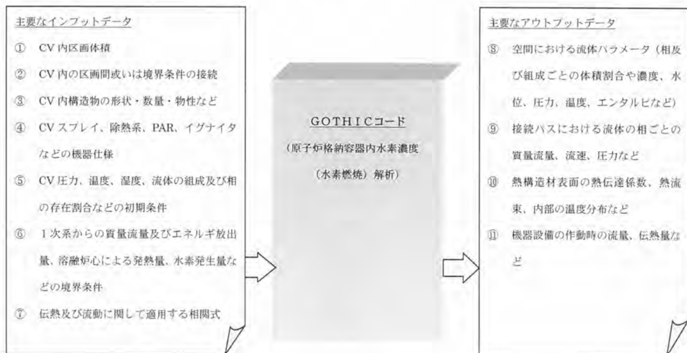
図 3-12 実機プラントにおける原子炉格納容器内水素濃度評価の概要
