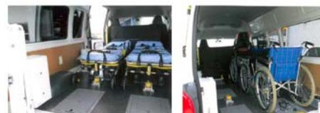
ストレッチャー2台・車椅子2台搬送(最大) 車椅子6台搬送(最大)
