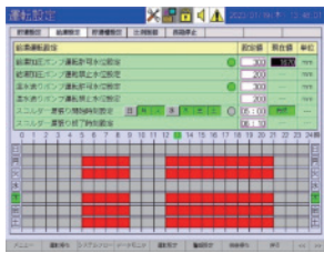
制御盤 スケジュール運転
