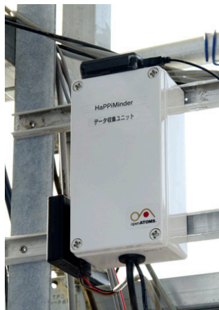
データ収集ユニットは、センサユニットの情報を収集・蓄積し、パソコンやスマートフォンなどに現在値やグラフ表示でデータを送る
