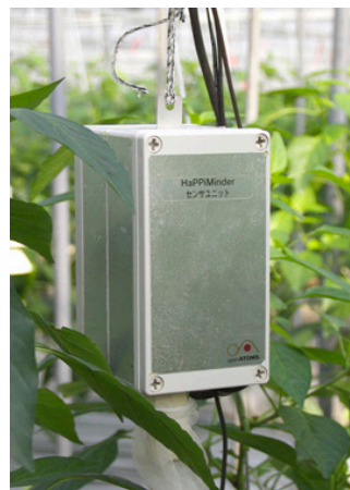
センサユニットは、室温・湿度・二酸化炭素濃度・日射強度などの情報を採取し、データ収集ユニットへ送信する
