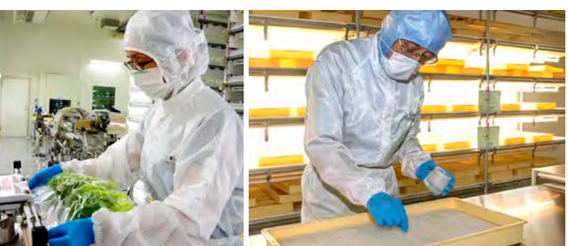
播種から最後の密封包装まで、クリーンルーム内で一連の作業を行う。生菌数が通常のレタスの10万分の1と圧倒的に少なく、水洗い不要のお手軽さと、日持ちの良さを実現
