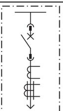
配電箱 | 配電箱<br>しゃ断器<br>変流器<br>零相変流器<br>配電盤 | 1個<br>1台<br>2台<br>1台<br>1面 } 配電箱に内蔵 |
