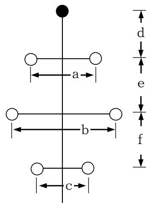
電線間隔 (公称電圧66kV) (単位:m)
