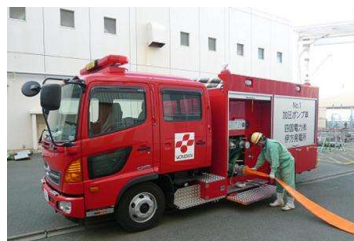
加圧ポンプ車
