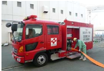
加圧ポンプ車
