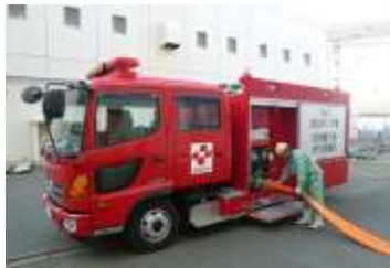
加圧ポンプ車
