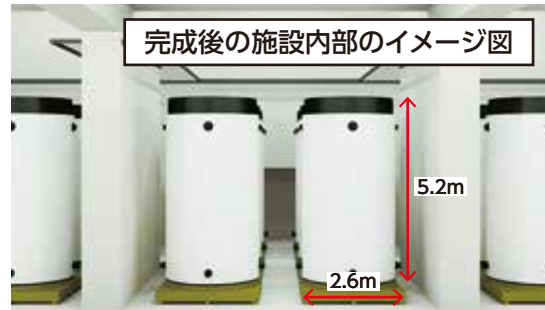
使用済燃料は金属製の頑丈な容器（乾式キャスク）に収納
