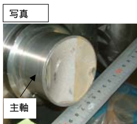
・軸端側折損面
