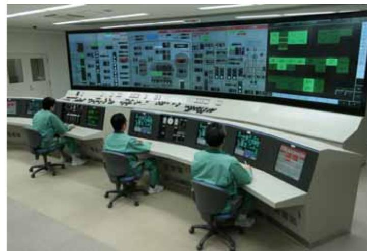
原子力保安研修所に新設されたシミュレータ研修用フルデジタル式中央制御盤で運転訓練に取り組む運転員
