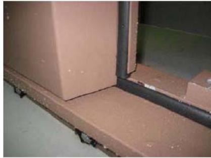
図－ 9 試験体の扉本体とシールゴムの納まり
