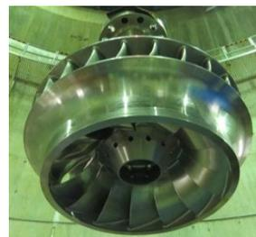
水の流れのロスを低減させるために、流動解析によって羽根形状を最適化し、羽根(長翼)の間に短い羽根(短翼)を設置
