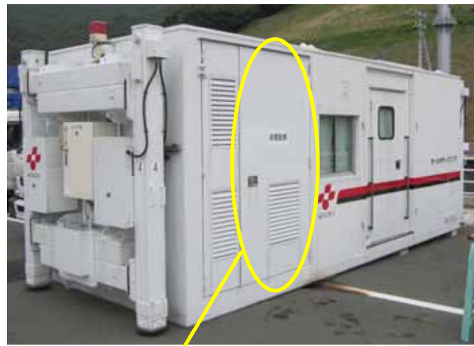
伊方発電所 コンテナ式ホールボディカウンタ
