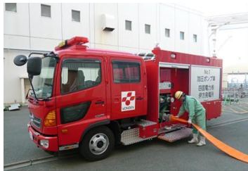
加圧ポンプ車
