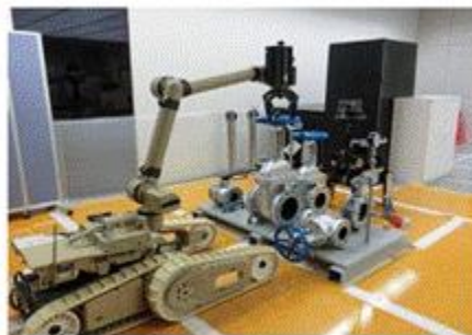
バルブの開閉操作
